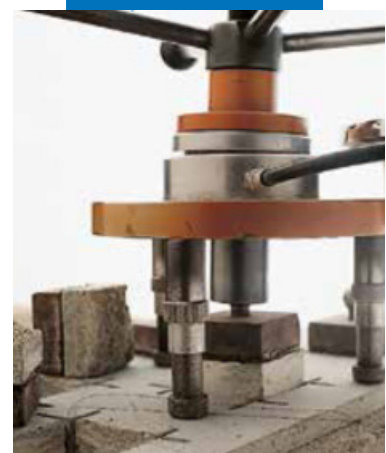
Испытание на адгезию SATTEC
